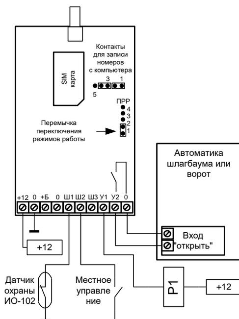
Полная схема подключения.
