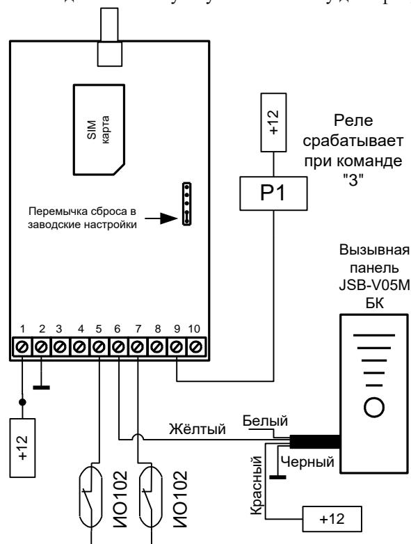
Схема электрическая подключения GSM-приставки к автономной вызывной панели JSB-V05M БК.
