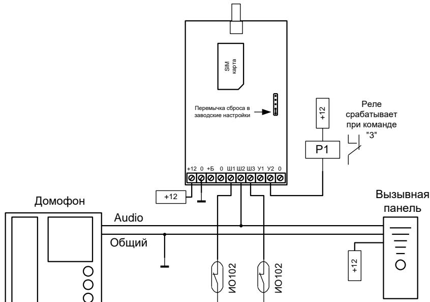
Схема подключения к уже установленному домофону
